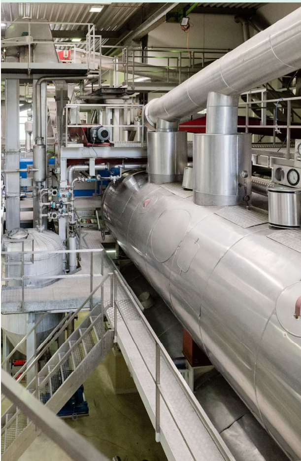
Anlage der GZM Extraktionswerk AG zur Sterilisation (Bild oben) und Trocknung (Bild unten) tierischer Proteine mit hohem Risiko. Installation de la société GZM Extraktionswerke AG pour la désinfection (image en haut) et le séchage (image en bas) des protéines animales à haut risque.
